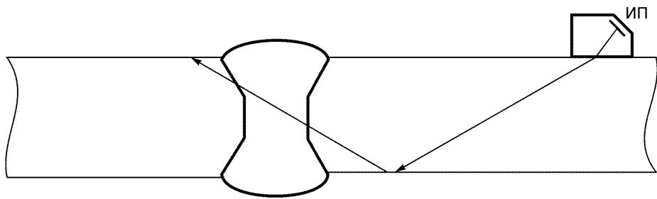
Рисунок 8. Схема прозвучивания стыкового сварного соединения однократно-отраженным лучом
