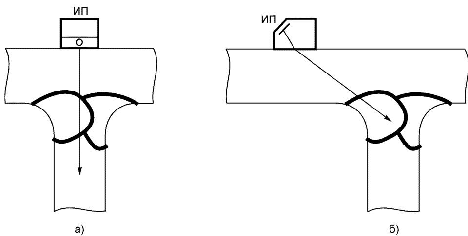
Рисунок 11. Схемы прозвучивания таврового сварного соединения прямым лучом
