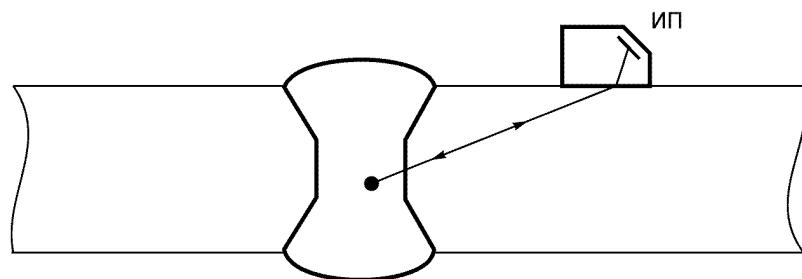
Рисунок 1. Эхо-импульсный
