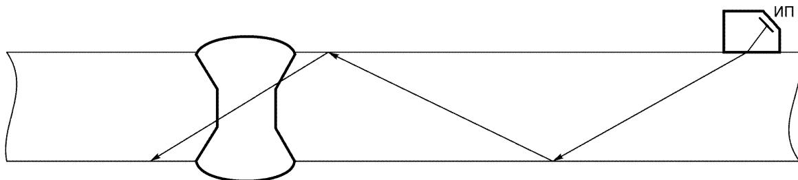
Рисунок 9. Схема прозвучивания стыкового сварного соединения двукратно-отраженным лучом
